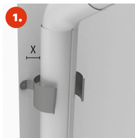
Putken takareunan (X) etäisyys seinästä n. 40 mm.
